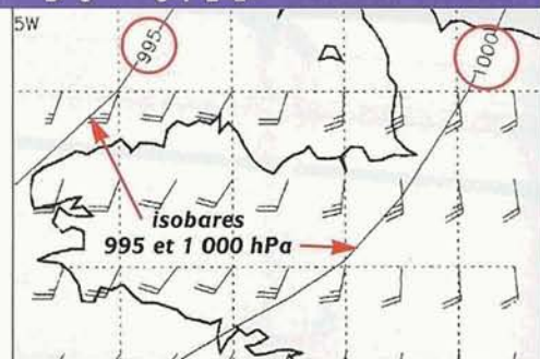
2 L'isobare. Au niveau de la mer («en surface», où l'altitude est constante à 0 mètre), tous les points ayant une même pression à un instant donné sont reliés par des lignes d'égale pression, baptisées isobares, tracées de 5 en 5 hPa.
